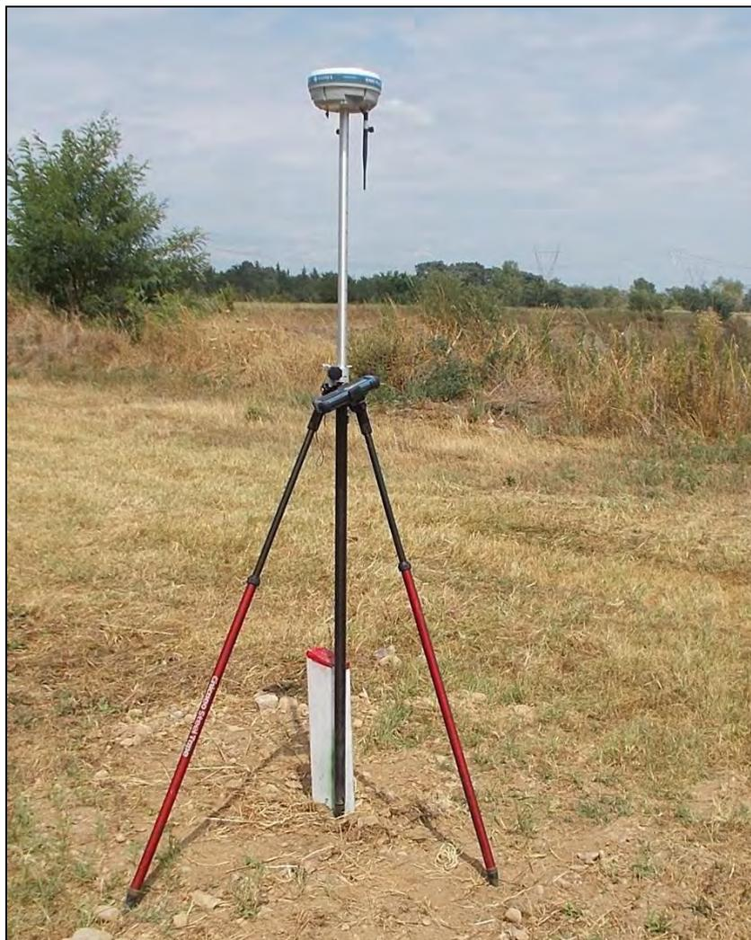
**Figura 2** Ricevitore GPS
