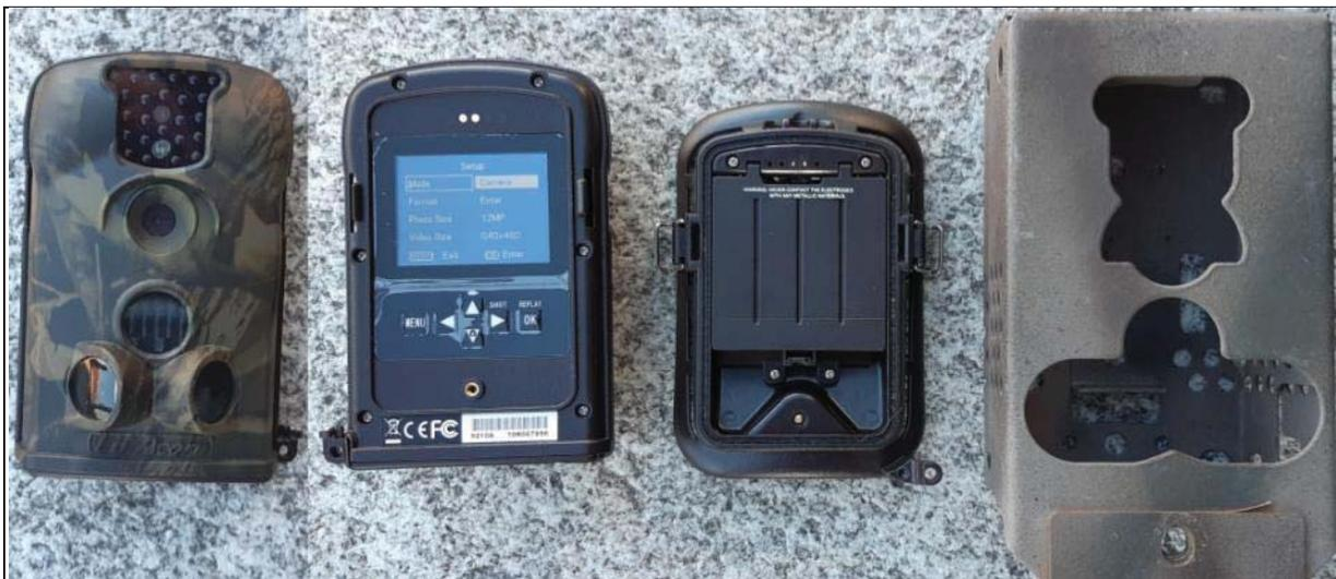
**Figura 2 - Dispositivo di ripresa Ltl Acorn 5210A e guscio protettivo utilizzato per il monitoraggio.**
